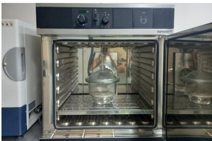
Figura 54. Estufa donde se realizó el calentado de vapores en el proceso del etilenglicol.
