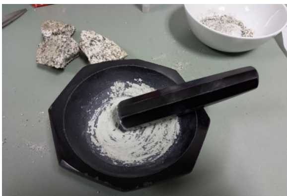
Figura 43. Mortero de ágata utilizado para pulverizar la muestra a tamaño <0.053\text{mm} (malla 200).
