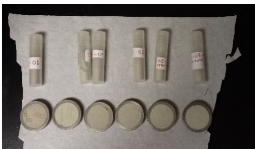
Figura 44. Muestras de roca total colocados en los portamuestras para ser introducidos en el difractómetro de rayos X y sus respectivos recipientes.
