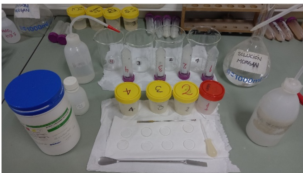
Figura 45. Implementos utilizados para la realización de la separación de la fracción arcilla.
