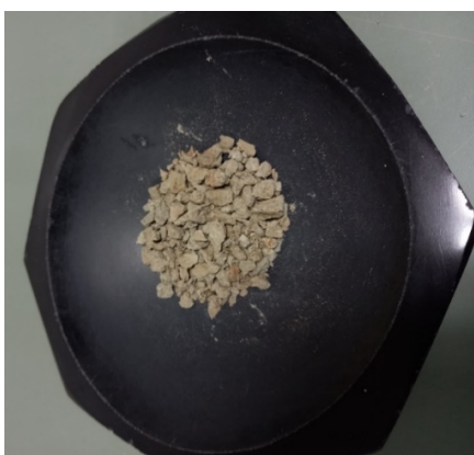
Figura 46. . Muestra triturada para separar la fracción arcilla.
