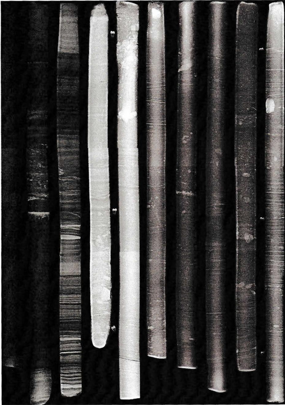
**Figura 4:** Mosaico de imágenes digitales de las radiografías tomadas al testigo PS0401B (Lago Eberhard). Cada segmento corresponde a ~1 m de sedimento, extraídos en forma continua. La base de cada segmento se continúa con el tope del siguiente, de modo que la base del testigo del extremo derecho de la imagen, corresponden a los sedimentos más antiguos y el tope del testigo del extremo izquierdo, los sedimentos más jóvenes.
