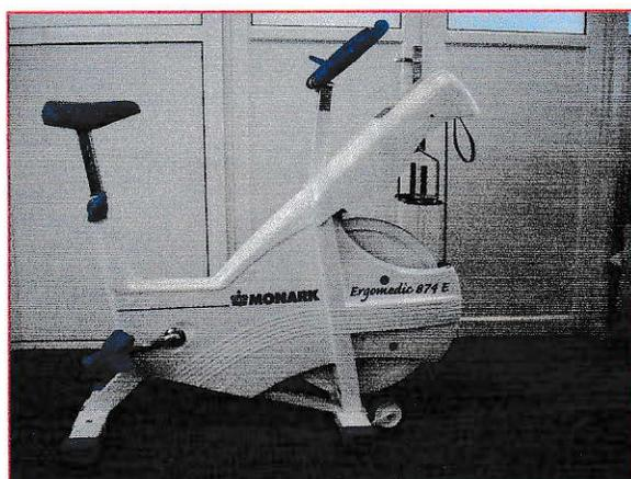
*Figura 22. Muestra cicloergometro para Wingate.*
