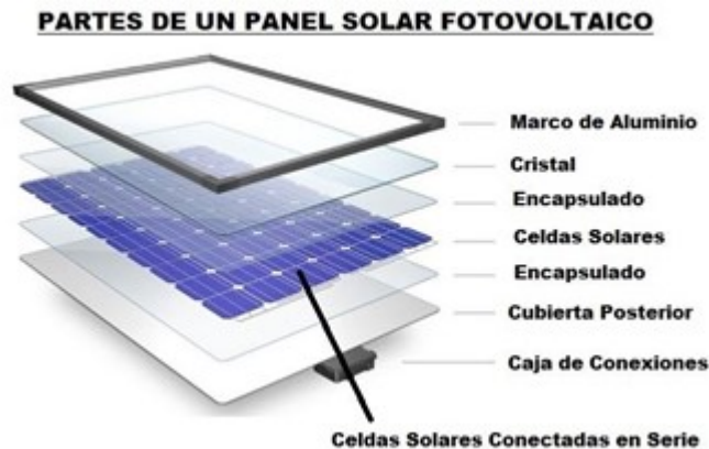
Figura 2.20: Estructura de un panel fotovoltaico (Romero, 2019).
