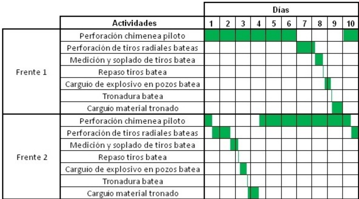
Figura 4.6: Carta gantt de las actividades de apertura de bateas llevadas a cabo en el nivel de producción.
