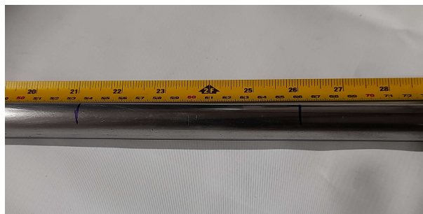
Figura D.6: Zona de trabajo posterior al tratamiento superficial.
