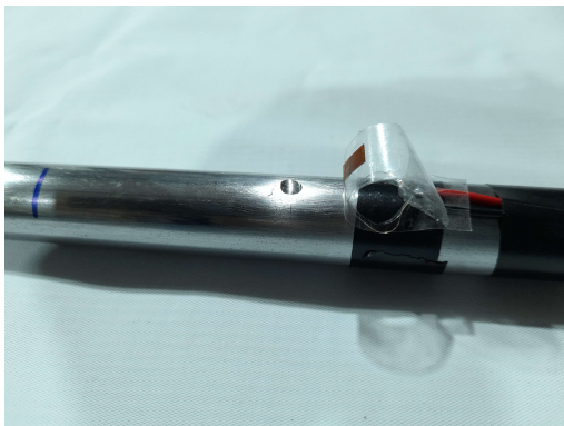
(a) Aplicación de adhesivo instantáneo en la zona de fijación.
