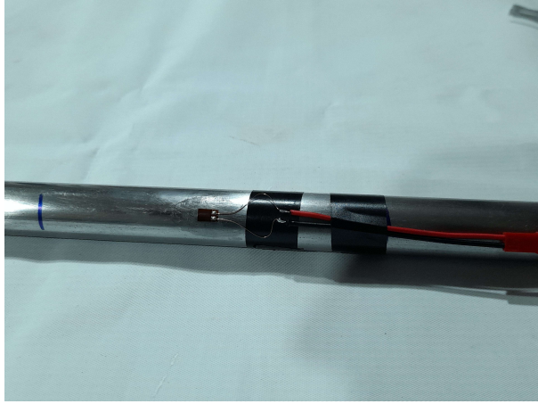
Figura D.18: Remoción de la cinta adhesiva de la zona de adhesión.
