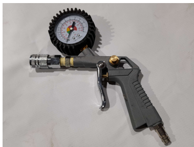
Figura 5.1.2: Inflador de neumáticos con manómetro graduado integrado y cople rápida hembra.
