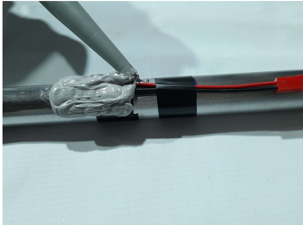
Figura D.19: Aplicación de aislante SikaFlex-11FC
