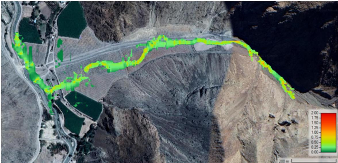
Figura 5.2: Modelo N° Courant quebrada La Mesilla, 1 segundo de Delta Tiempo
