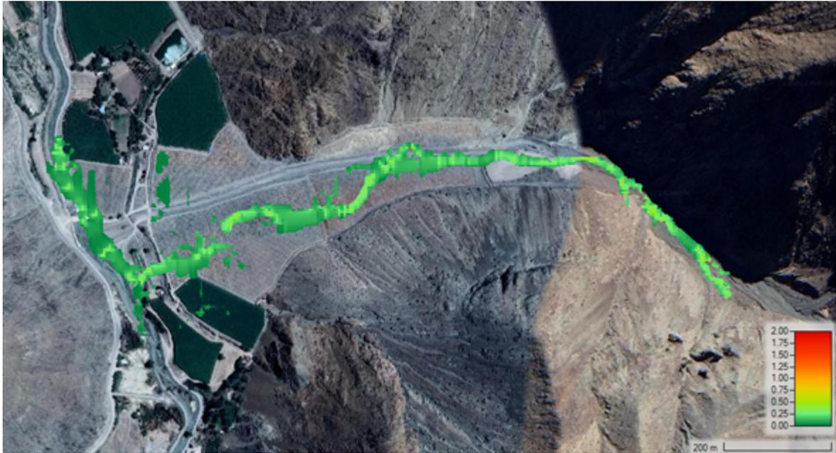
Figura 5.1: Modelo N° Courant quebrada La Mesilla, 0,5 segundos de Delta Tiempo
