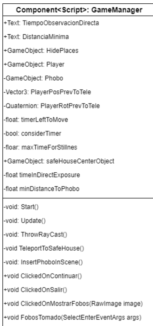
Figura 4.18: Diagrama UML del componente
