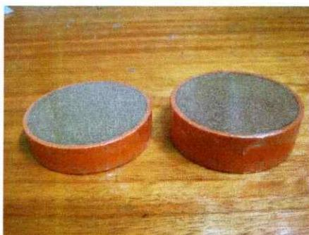
Figura 7.4: Fuentes radiactivas cilíndricas. Se utilizó un tubo de PVC a modo de contenedor el cual fue sellado con mylar.
