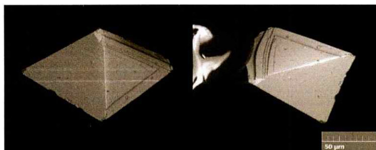
Figura 13. Imagen SEM del Monocristal \text{CuCr}_{1.7}\text{Sn}_{0.3}\text{Se}_4
