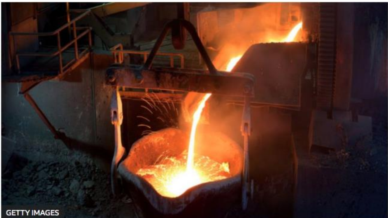
Proceso fundición cobre . Fuente Getty Imágenes, BBC Mundo
