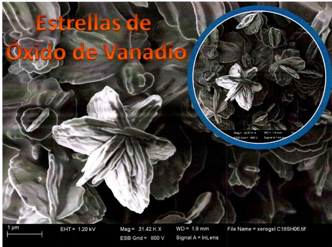
Figura III.4.1 Microscopía FESEM nanoestrellas de óxido de vanadio utilizando 1-octadecanotiol como surfactante.
