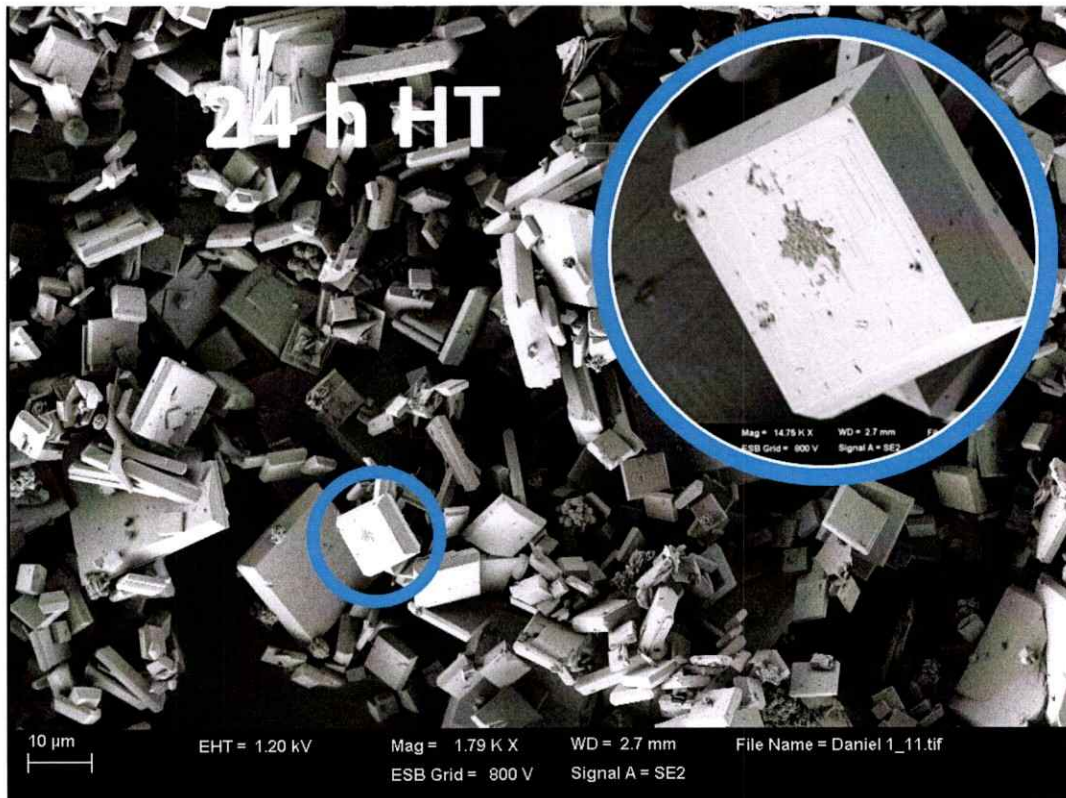
Figura 4.2.8 Micrografía FESEM de los cristales de (\text{NH}_4)_2\text{V}_7\text{O}_{16} sintetizados con 24 horas de tratamiento hidrotermal.
