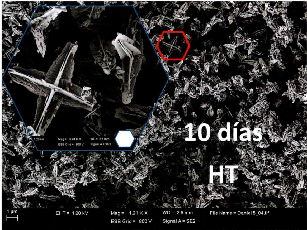
Figura 4.3.2 Micrografía SEM de la estructura con morfología de cruz de V_xO_2 .
