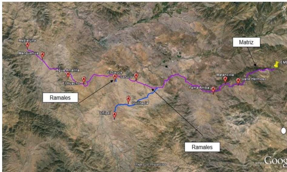
Figura 4.13: Trazado de tuberías. Fuente: Subdirector SSR Región de Coquimbo vía Ley de Transparencia, 4 de junio 2021.
