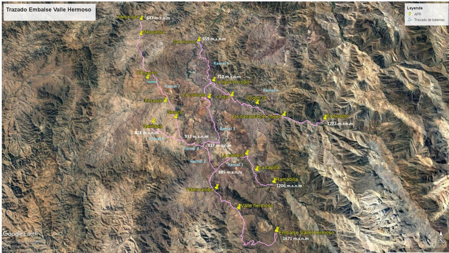
Figura 6.3: Trazado embalse Valle Hermoso hasta APRs. Elaboración propia.
