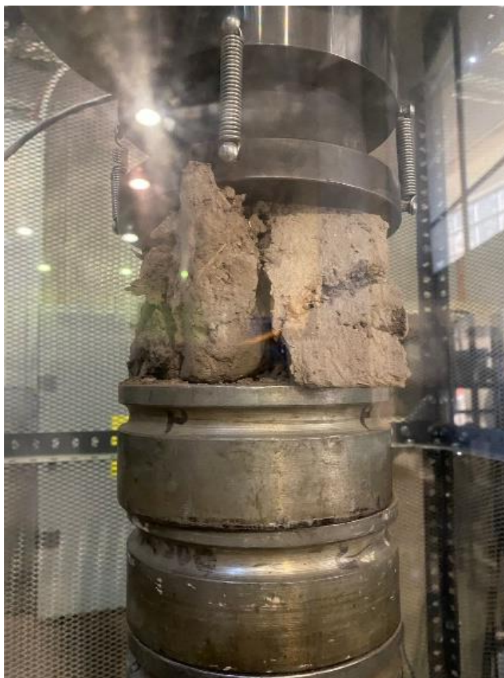
Figura 3.3-21: Probeta cúbica adobe Livilcar ensayada bajo compresión.
