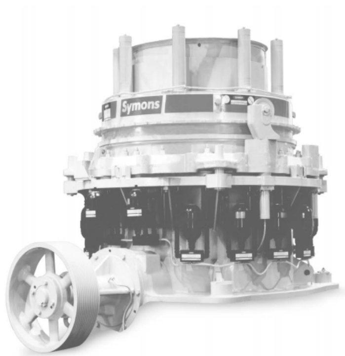
Figura 2.5: Chancador de cono utilizado en las secciones B, D y E de la planta de chancado secundario y terciario. Fuente: Manual de servicio, Chancador de Cono Symons 4 \frac{1}{4} ', 5 \frac{1}{2} ' & 7'.
