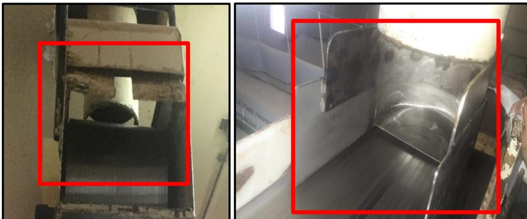
*Figura 6.4.3 Antes y Después de la caída de masa desde el Pre-refinador a la cinta de alimentación de los refinadores de L1.*
