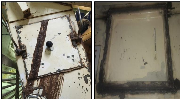
*Figura 6.4.2 Antes y después de filtración de masa en las compuertas sin uso de los refinadores*
