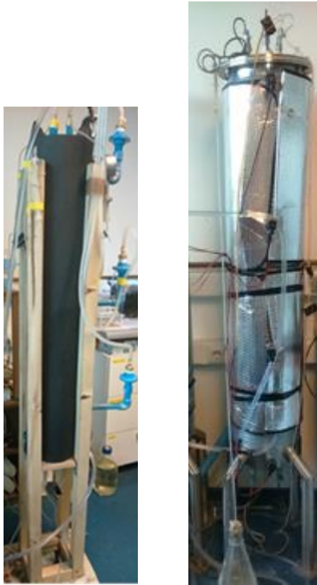
Figura 4. Fotografía de la columna experimental y una columna definitiva. La imagen de la izquierda corresponde a la columna exploratoria y la de la derecha a la columna definitiva. Se observan las conexiones de mangueras transportadoras de medio de cultivo y las mangueras del baño termostático.
