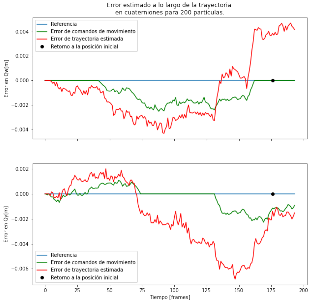
Figura 4.33: Errores a lo largo de la trayectoria para Q_w y Q_y al ocupar 200 partículas. Se observa una diferencia moderada de la trayectoria estimada respecto a los comandos de control.
