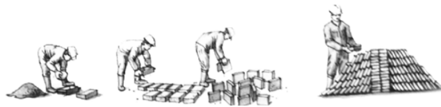
Figura N°1: Ilustración del proceso cración del adobe. Fuente: Hernández, 2016.
