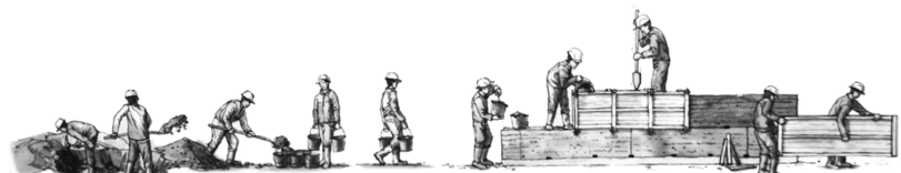
Figura N°2: Ilustración del proceso cración del tapial. Fuente: Hernández, 2016.
