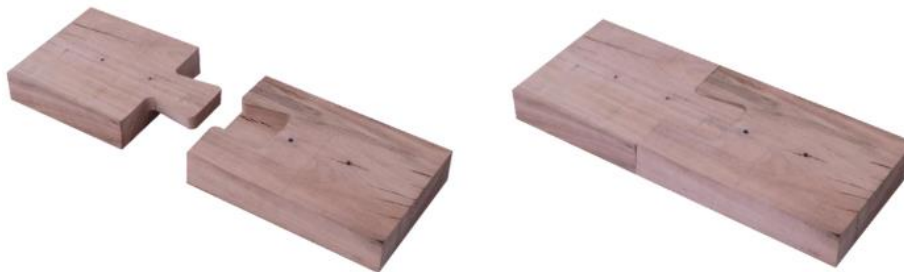
Figura 29: Ensamble media cola de milano prototipo en coigüe con tolerancia 0.1 mm.
