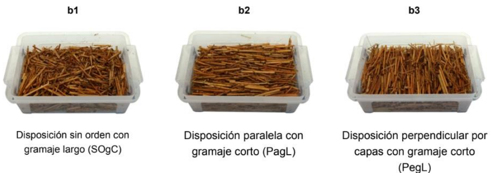
Figura 4: Seis variaciones en la composición del sustrato en las matrices para la producción de las muestras de biocompuesto. Grupo: (a) gramaje mayor, (b) gramaje menor. Tipo: (1) Sin Orden, (2) Paralelo, (3) Perpendicular. Elaboración propia.
