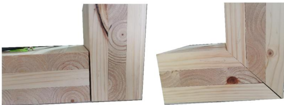
Izq. Figura 48: Tolerancia 2mm en pieza 3' ángulo corte en 90°. Nota. Elaboración propia, 2022
