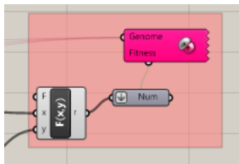
Figura 12: Conexión de componente función con output numérico para conectar al fitness de Galapagos.
