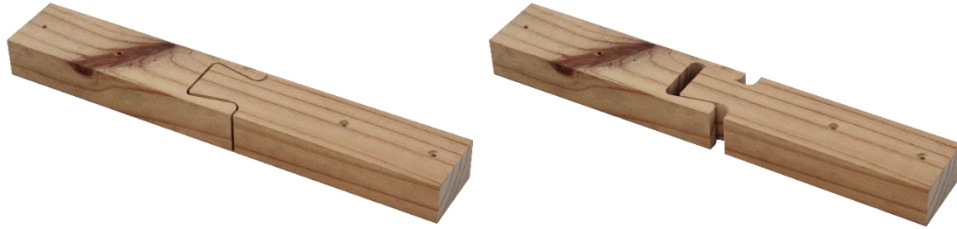
Figura 9: Ensamble cola de milano prototipo 2 mm | Desplazamiento a tracción de 15 mm.
