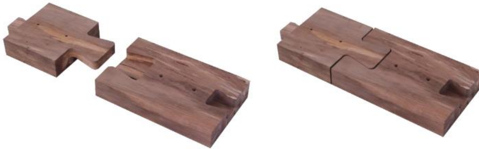
Figura 26: Ensamble media cola de milano prototipo en canelo con tolerancia 0.1 mm.
