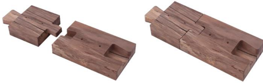
Figura 25: Ensamble media cola de milano prototipo en canelo con tolerancia 0.2 mm.
