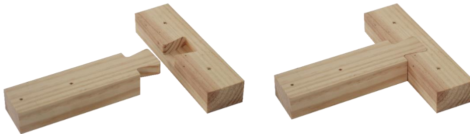
Figura 5: Ensamble media cola de milano. Fuente: Elaboración propia.
