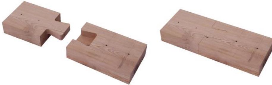
Figura 27: Ensamble media cola de milano prototipo en mañío con tolerancia 0.1 mm.
