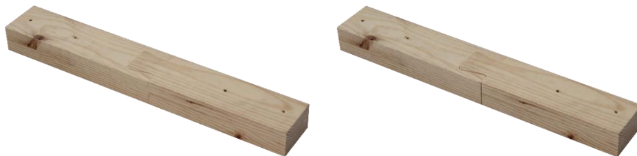
Figura 12: Ensamble cola de milano prototipo 0.2 mm ingreso eficaz | Desplazamiento a tracción de 1 mm.
