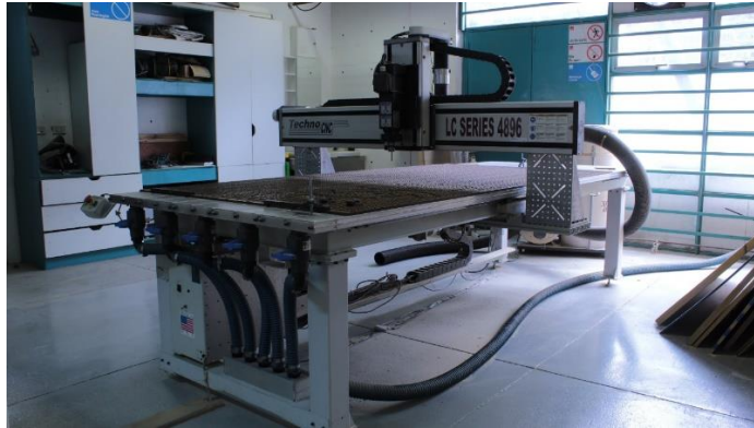
Figura 1: Router CNC LC Series 4896. Fuente: Elaboración propia.
