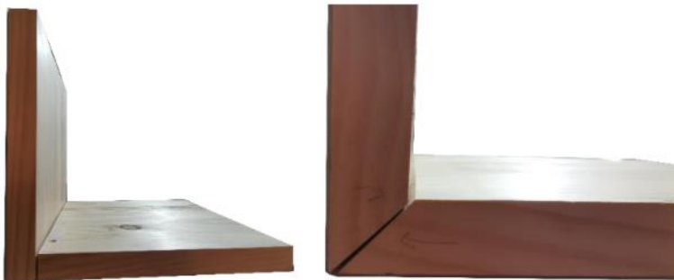
Izq. Figura 46: Tolerancia 2mm en pieza 1' ángulo corte en 90°. Nota. Elaboración propia, 2022
