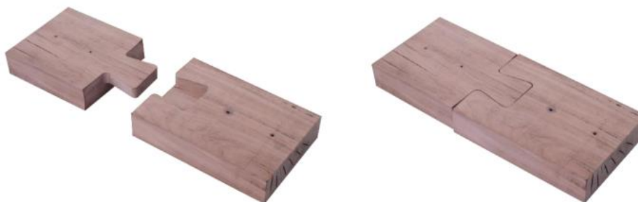
Figura 30: Ensamble media cola de milano prototipo en coigüe con tolerancia 0 mm.
