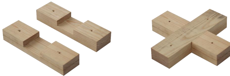
Figura 14: Empalme media madera en cruz prototipo tolerancia 0.2 mm.
