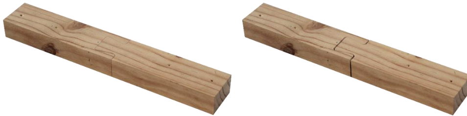
Figura 10: Ensamble cola de milano prototipo 0.5 mm | Desplazamiento a tracción de 3 mm.
