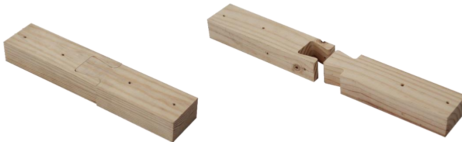
Figura 11: 1. Ensamble cola de milano prototipo 0.3 mm curvaturas interiores estrechas | 2. Ensamble cola de milano prototipo 0.1 mm no ingresa. Fuente: Elaboración propia.
