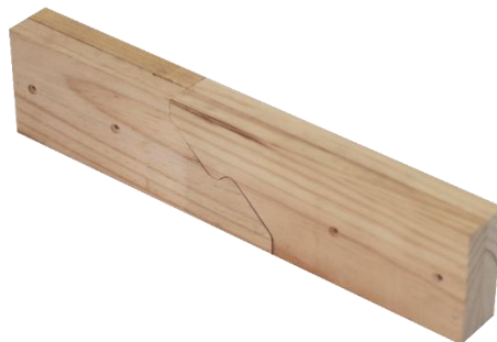
Figura 17: Empalme rayo de júpiter prototipo tolerancia 0.2 mm | Contacto y fricción eficaz.
