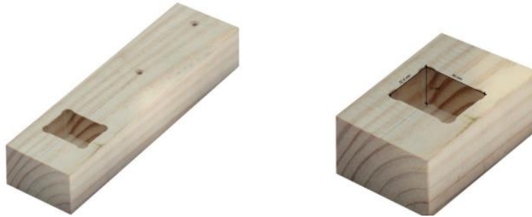
Figura 18: Dimensiones (X Y y Z) de la pieza caja del ensamble caja y espiga.
