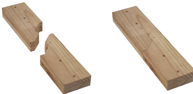
Figura 6: Empalme rayo de júpiter. Fuente: Elaboración propia.
