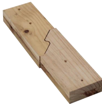
Figura 16: Empalme rayo de júpiter prototipo tolerancia 0 mm | Desfase en las caras y piezas.
