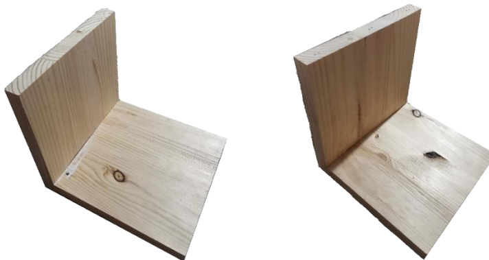
Izq. Figura 29: Posición 1 piezas de 1' unión 90°. Der. Figura 30: Posición 1 piezas de 1' unión 45°.
