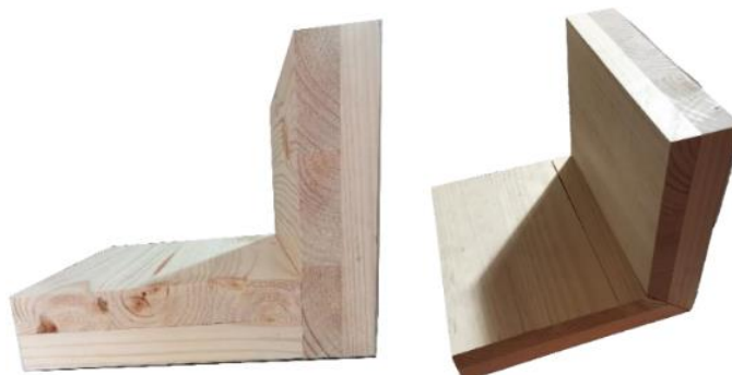
Izq. Figura 31: Posición 1 piezas de 2' unión 90° Der. Figura 32: Posición 1 piezas de 2' unión 45°.
