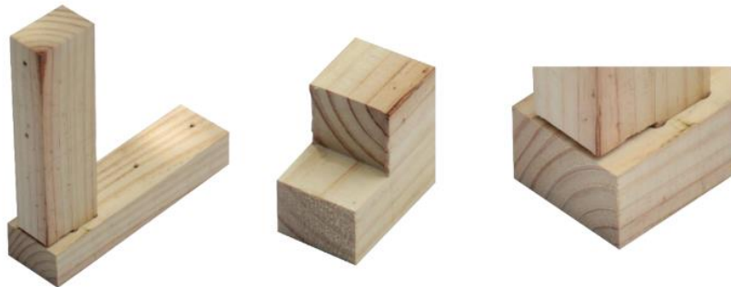
Figura 20: Ensamble caja y espiga unilateral | Detalle espiga 2 | Detalle ensamblaje.
