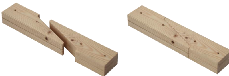
Figura 15: Empalme pico de flauta prototipo tolerancia 0 mm. }
