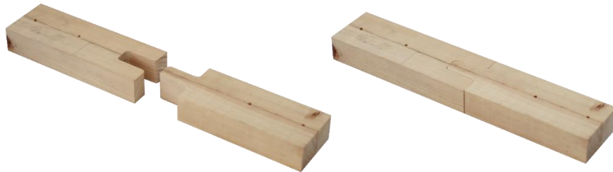
Figura 13: Empalme quijera prototipo tolerancia 0.2 mm.
