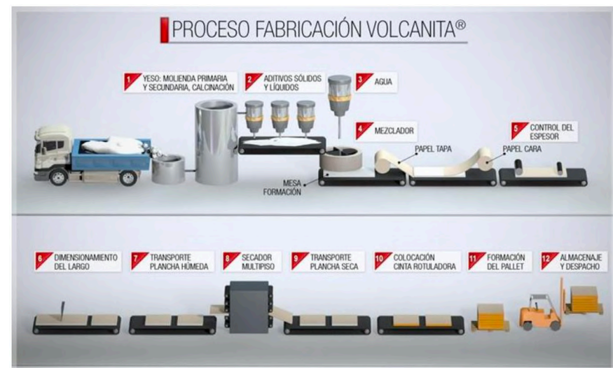
Figura 8: Proceso fabricación volcanita Fuente: Volcán, 2016
