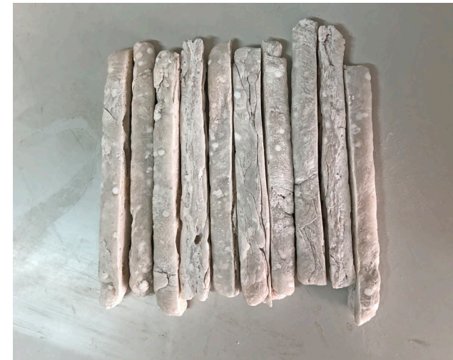
Figura 33: Probetas para ensayo Flexión Fuente: Elaboración propia, 2021.
