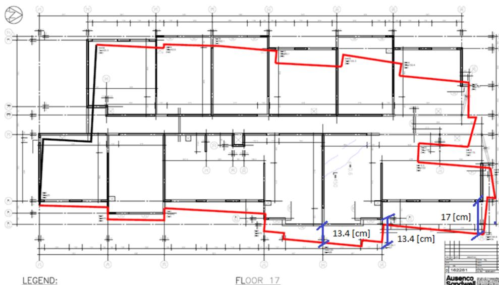
**Figura 3-25.** Desplome medido en la planta de techo del piso 17. Fuente: Informe AUSENCO.
