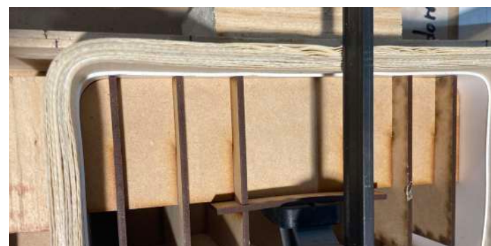
Figura 112. Proceso laminación de madera, fuente propia, 2022.
