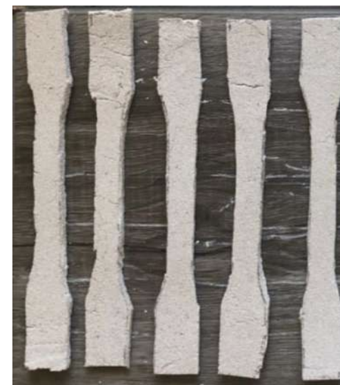
Figura 10. Probetas de hueso de material HX01 para realizar pruebas mecánicas, 2020. Fuente: Elaboración propia.
