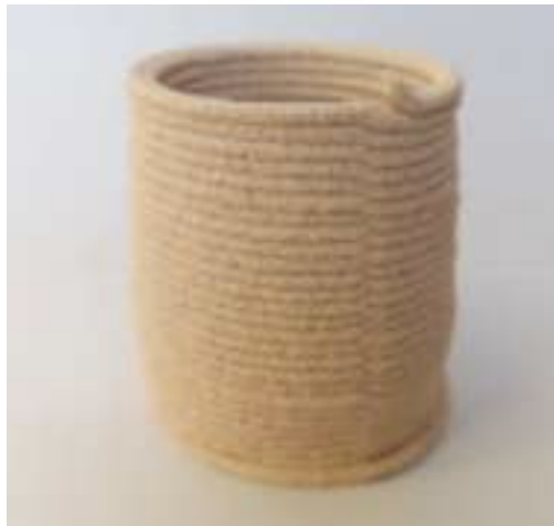
Eggshell paste for 3d printing Ana Otero, coudre.studio Ingredientes: Agua, cáscara de huevo, goma xantan.
