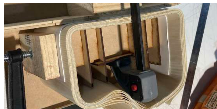
Figura 113. Proceso laminación de madera, fuente propia, 2022.
