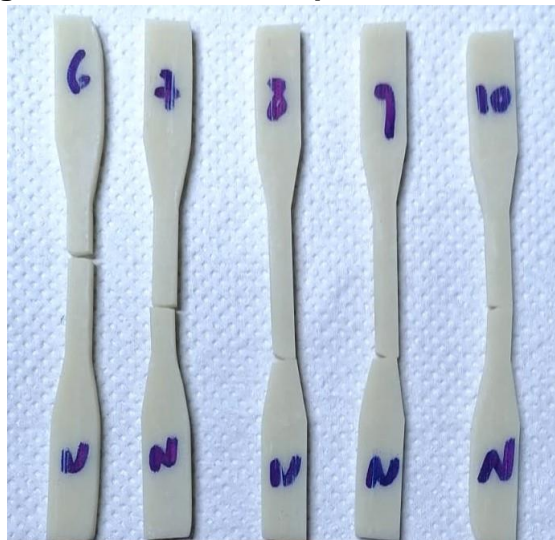
Figura 20: Fractura de probetas Next Dent
