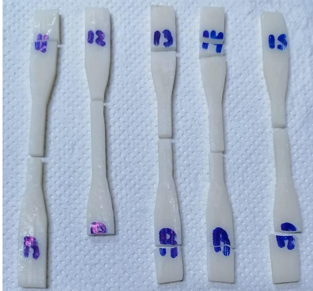
Figura 21: Fractura de probetas Raydent
