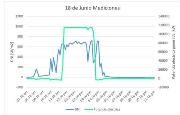
(b) Producción eléctrica con datos de las mediciones.
