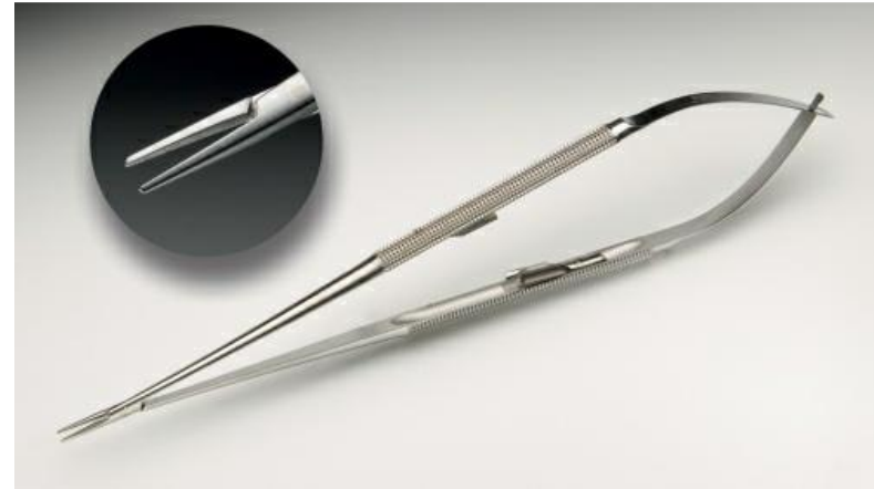
Fig. 65. Porta agujas con precisión. Fuente: (Nemitz, 2019).
