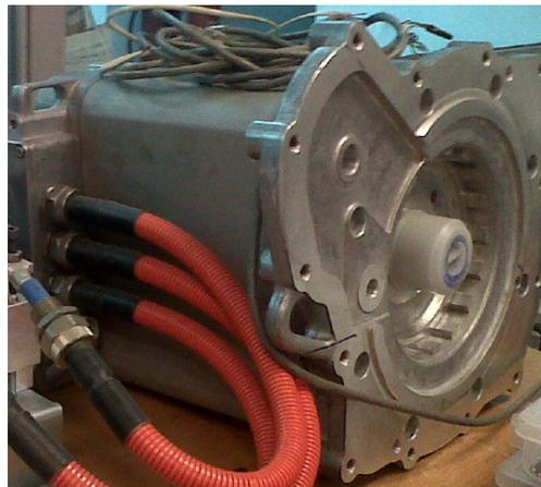
Figura B.23: Motor de inducción Siemens 1PV5133-4WS20 W11
