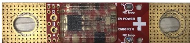
Figura B.6: Sensor CM60 de la empresa EV Power.
