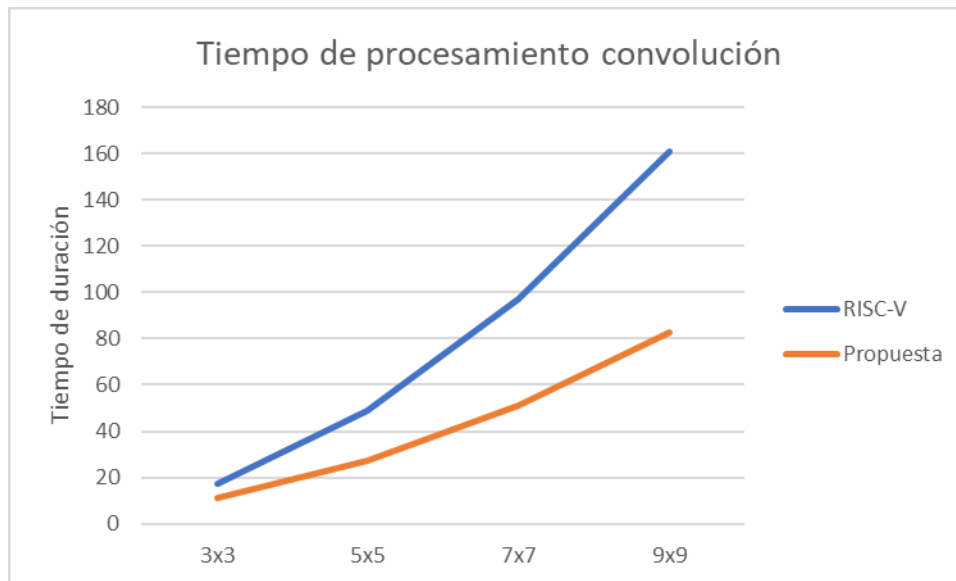
Figura 4.1: Gráfico comparativo de tiempos de ejecución entre RISC-V y la propuesta de solución para la convolucion
