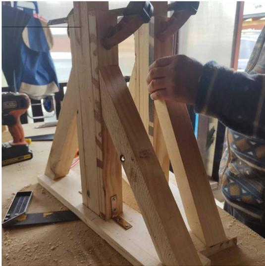
En un principio se ideó dos bases tipo pizarra de forma triangular, que tendría ensamblados de manera vertical un palo de 1 metro 80 cm. Esos palos tendrían incisiones para que insertar dos tubos de aluminio tipo cortina que cumpliría de sostenedor y tensor de la tela.
