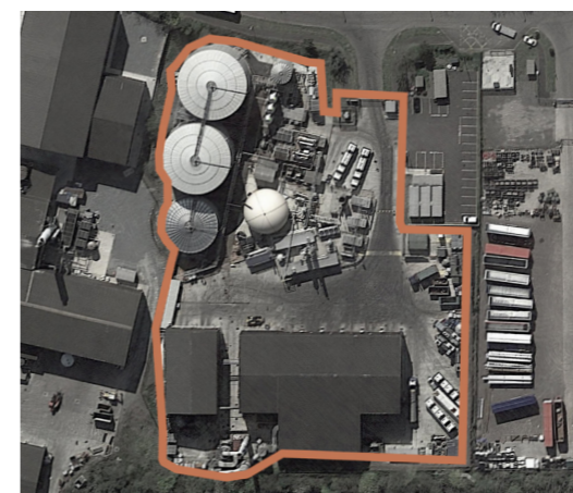
Granville Eco Park / Irlanda Capacidad 75.000 toneladas al año Superficie planta: 9.800 m 2 Empresa Granville EcoPark Beneficios: generación eléctrica de 3 MW y gas (biometano) para su flota de camiones
