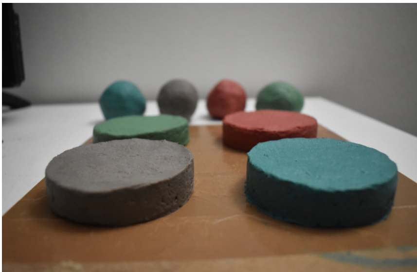
Figura 40. Proceso de coloración, resultado húmedo y seco. Fuente: Elaboración propia.
