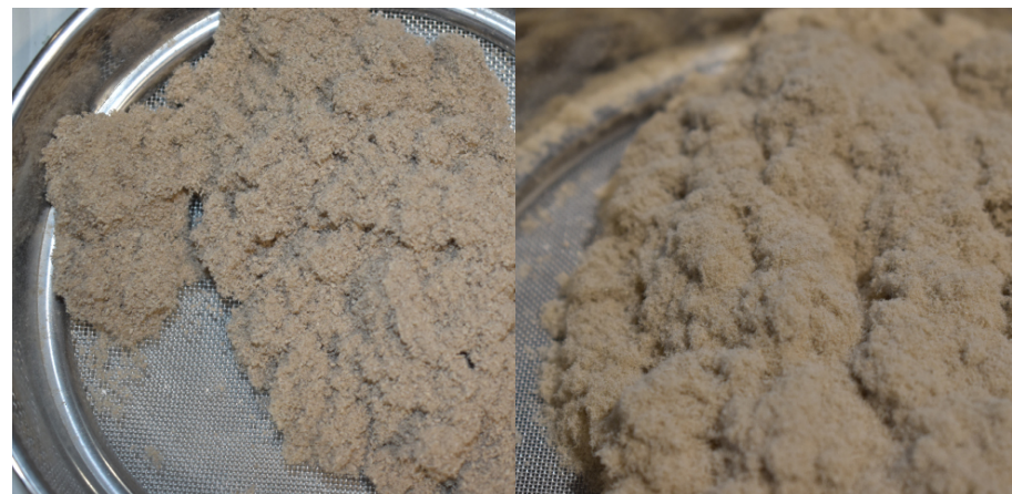
Figura 22. Tamizado del residuo (18 y 35 mesh). Fuente: Elaboración propia.
