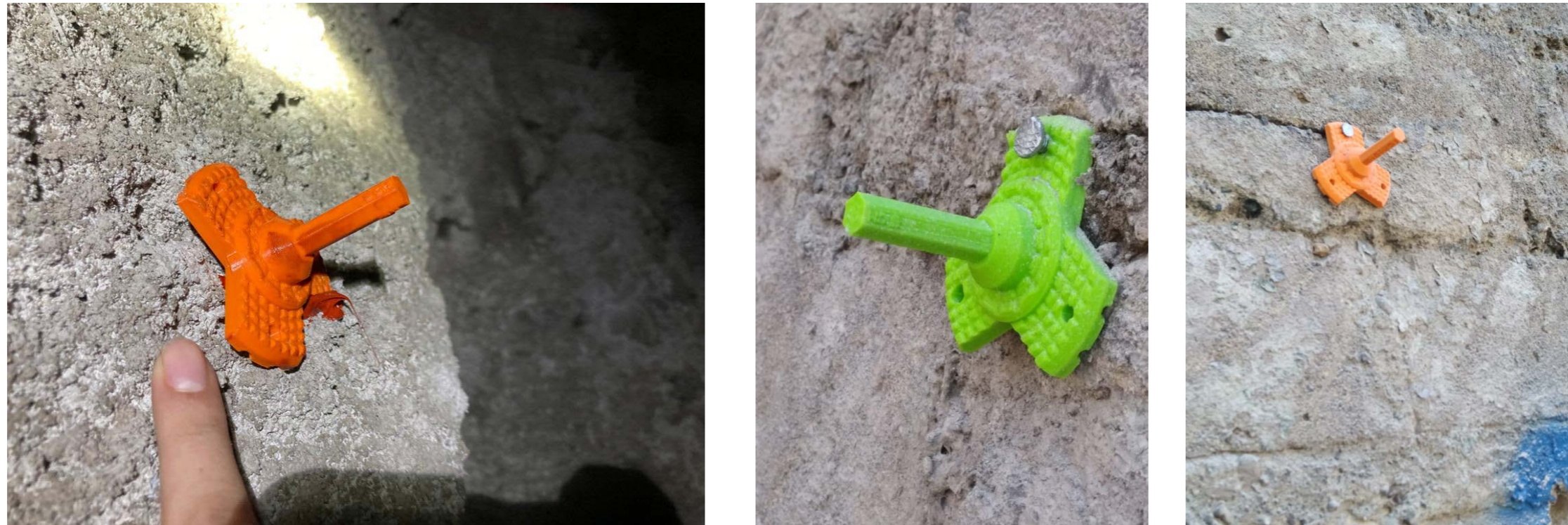
Figura 148, 149, 150: Fotografía de la primera versión del diseño para roca en pruebas de uso utilizando silicona roja y clavos como unión al sustrato. A solicitud de la autora.
