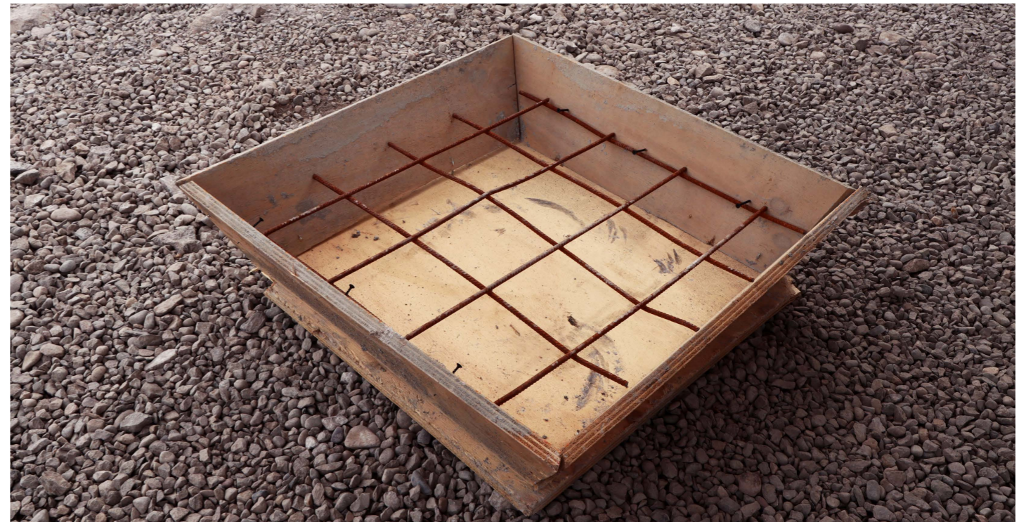
Figura 83: Cajón para prueba de shotcrete con malla. Foto a solicitud de la autora.
