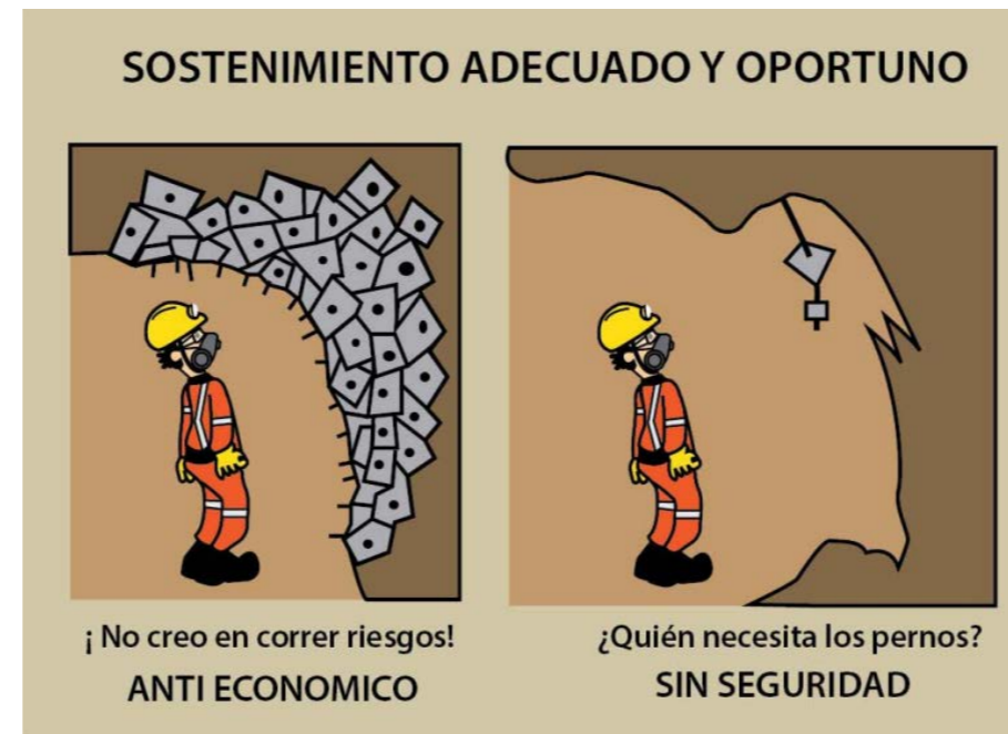
Figura 7: Ilustración que demuestra que la fortificación debe ser oportuna y no exceder a los extremos. Fuente: (SERNAGEOMIN, 2018)
