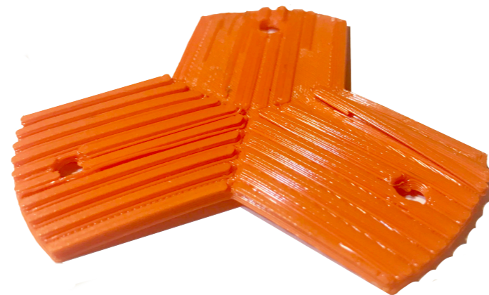
Figura 51: Primer prototipo experimental de la base. Elaboración propia.
