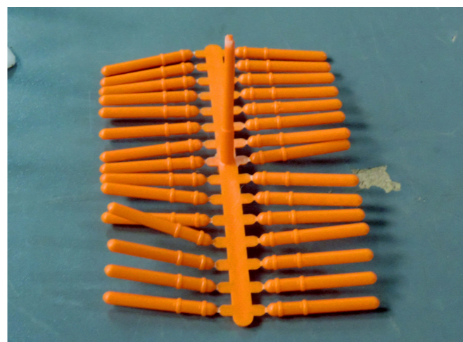
Figura 139: Primeras pruebas de inyección en puntas. Elaboración propia.
