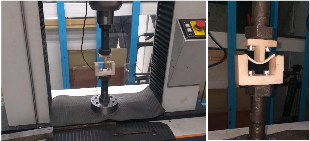
Imagen 5. En la imagen de la izquierda se muestra la máquina de testeo universal Instrom 4206 con una probeta cargada al inicio de la prueba de flexión en 3 puntos. En la imagen de la derecha se muestra el desplazamiento generado durante el desarrollo de la prueba, siendo esto registrado automáticamente en el software de la máquina .
