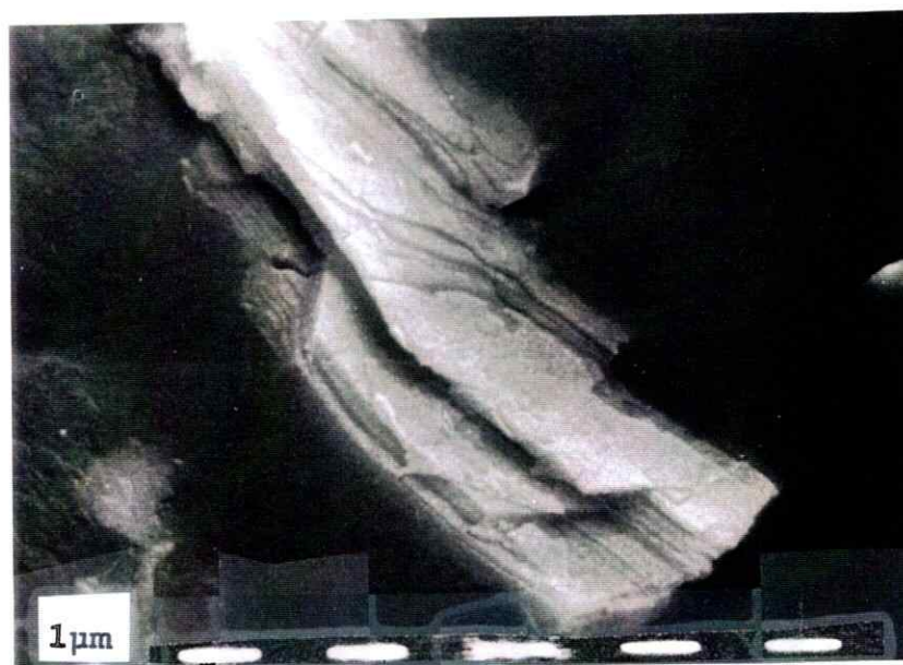
Figura. 4.4 Fotomicrografía del compuesto de \text{MoS}_2 intercalado con estireno.
