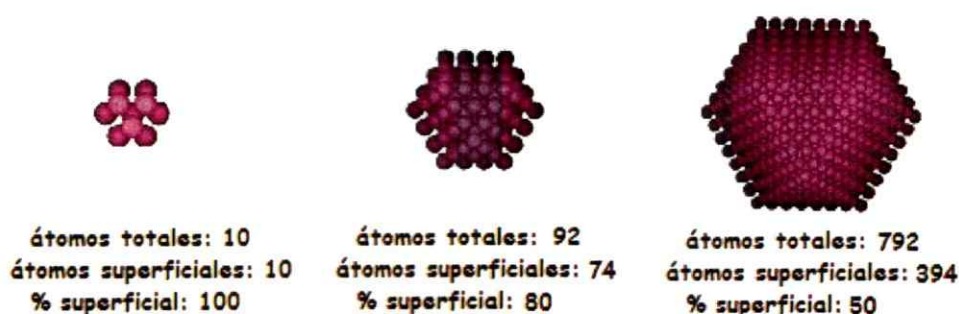
Figura 1.4. Representación del número de átomos totales y superficiales en función del número de capas.
