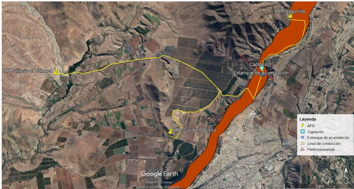
Figura 5.3.3: Ubicación de captación y estanque de almacenamiento, junto con línea de distribución para abastecimiento en APRs en el Sector Quebrada Ingenio.
