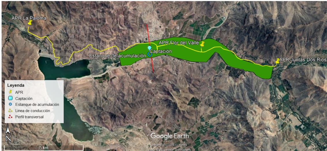
Figura 5.3.8: Ubicación de captación y estanque de almacenamiento, junto con línea de distribución para abastecimiento en APRs en el Sector Río Grande. Elaboración propia.
