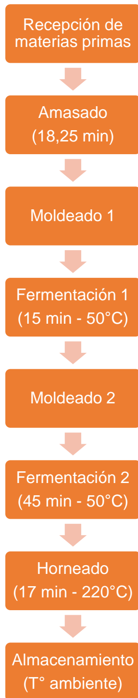
Figura 3. Diagrama de bloques del proceso de elaboración de pan marraqueta.
