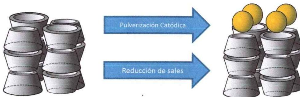
**Figura 6.** Representación esquemática de la nanodecoración con partículas obtenidas por reducción de sales de metal (método químico) y por pulverización catódica (método físico).
