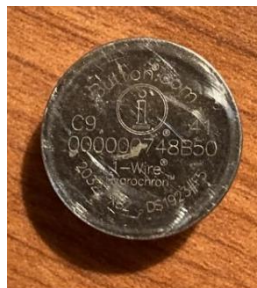
Figura 8: Dorso inverso del iButton, el cual muestra el tipo (Hygrochron) y el ID
