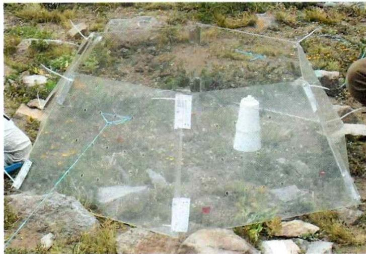
Figura 9. Al interior de un OTC se observa un Hobo sombreado.
