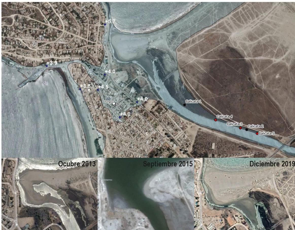
**Figura 27.** Carta de inundación del tsunami de 2015 en Tongoy modificada de Aránguiz *et al.* (2017), abajo imágenes de la evolución de la barra de arena del estero Tongoy pre y post tsunami.
