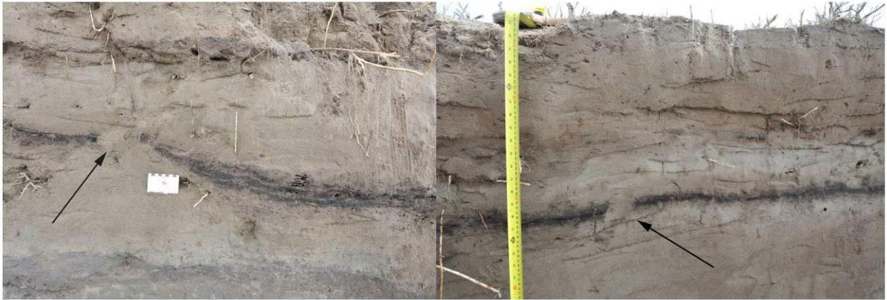
**Figura 33.** Estructuras producto de la erosión del tsunami sobre la capa subyacente Calicata 4.
