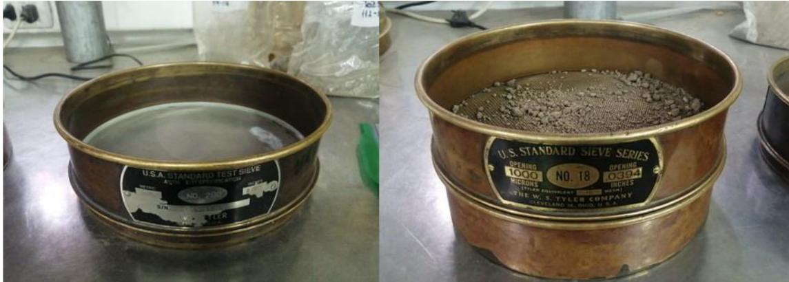
Figura 16. Tamices malla 200 (izq.), malla 18 (der.)
