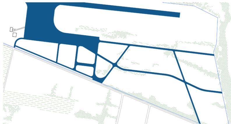
Se incluyen las vías secundarias y se expande el pavimentado del acceso de la pista para quedar conectado con la nueva trama.
