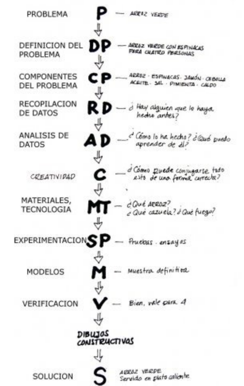
Figura 3. Esquema del método proyectual de B. Munari con ejemplo de receta para cocinar arroz verde.
