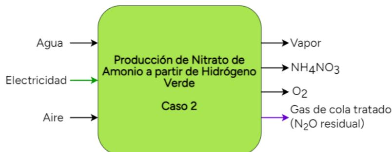
Figura 3.4: Límite de batería de la producción de nitrato de amonio desde hidrógeno verde.
