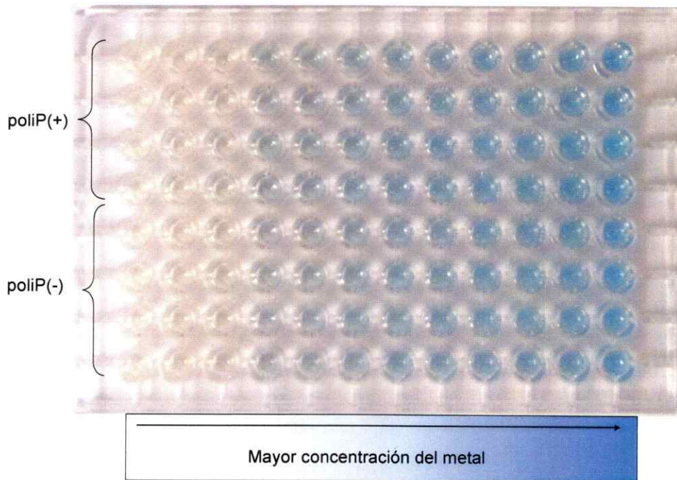
Figura 5. Esquema del ensayo de determinación de la MIC de Cu en placa de 96 pocillos. Cada columna de la placa tiene una concentración diferente de Cu: 0, 1, 2, 5, 6, 7, 8, 9, 10, 11, 12, 15 mM.
