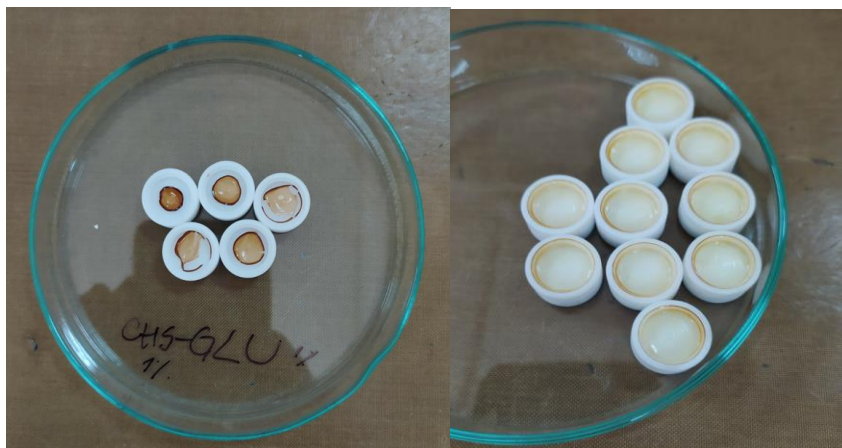
Figura 13: Comparación de CHS/GLU 1% y CHS/GLU 0,1% por método de reticulación previo al secado.
