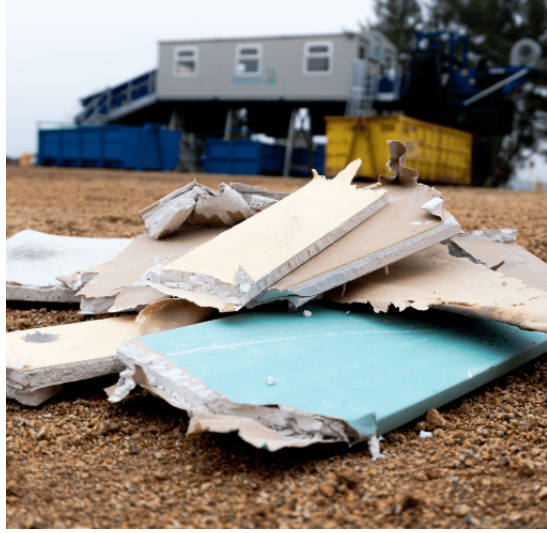
Figura 3.27: Separación de residuos en yesos para la reutilización como materia prima. Fuente: ( revaloriza.cl , 2022)
