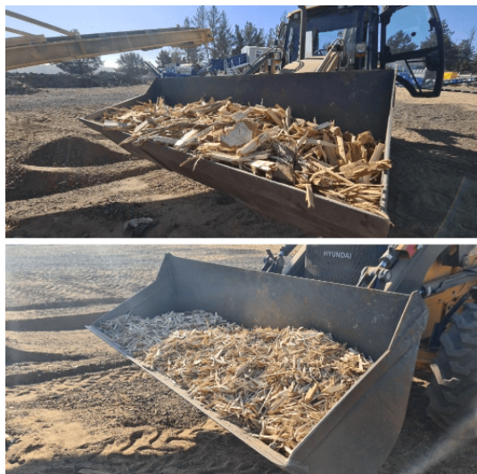
Figura 3.23: Separación de residuos de madera para la reutilización como materia prima, mediante trituración. Fuente: ( revaloriza.cl ,2022)
