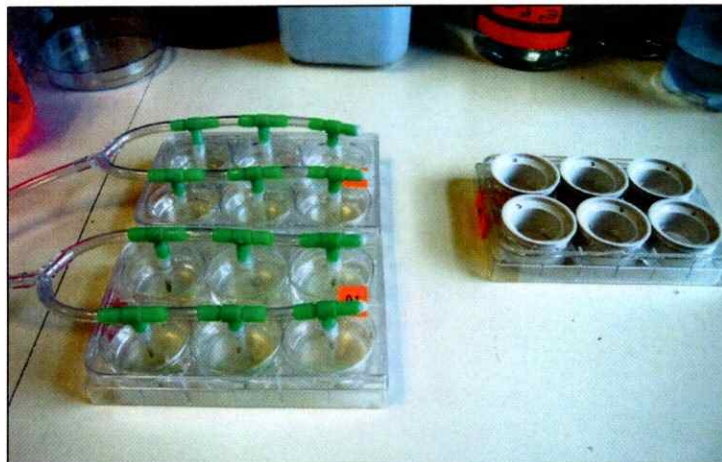
Figura 7. Montaje de los experimentos de optimización. Izquierda: Bioensayo de contacto con sistema de aireación constante (SAC). Se observa la red de conductos. Derecha: Bioensayo de contacto con mínimo volumen de agua (MVA). Se observan los insertos.
