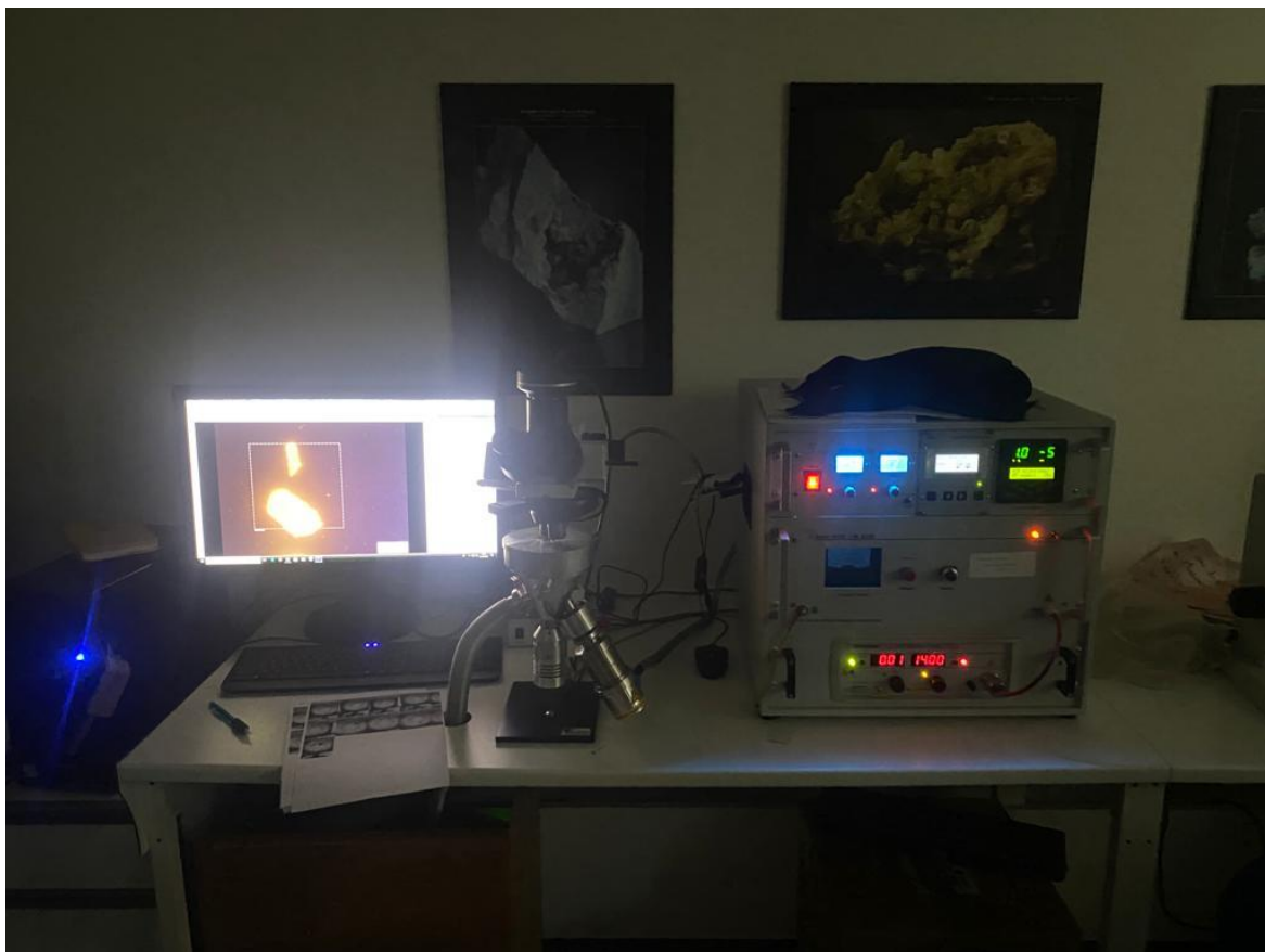
Figura 4.4 Equipo de catodoluminiscencia marca Lumic HC6-LM montado sobre un microscopio petrográfico Olympus XC-10 localizada en el Géosciences Environnement Toulouse (GET, Francia).
