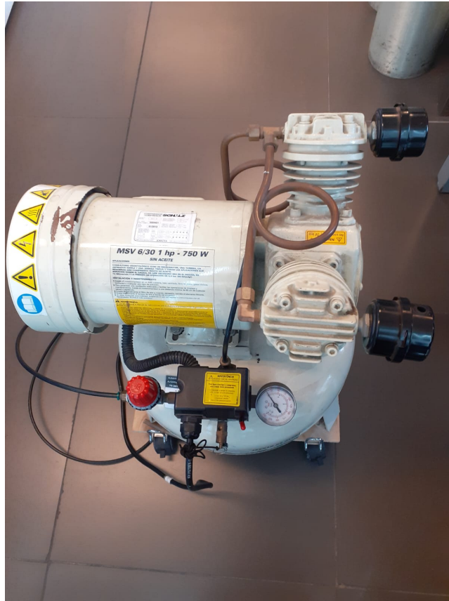
Figura 2.13: Compresor usado para llevar a cabo las pruebas de fuga.
