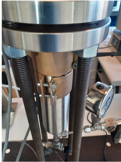
Figura 2.6: Calefactores instalados en el equipo.
