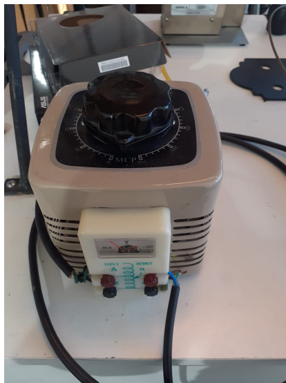
Figura 2.7: Variac monofásico para la regulación de voltaje.
