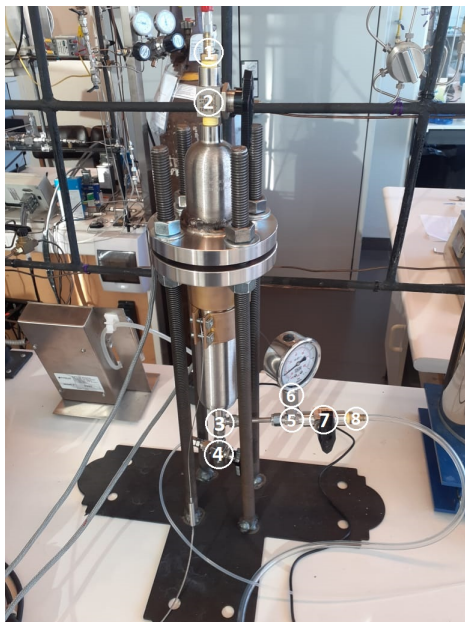
Figura 2.10: Conexiones instaladas en el equipo.
