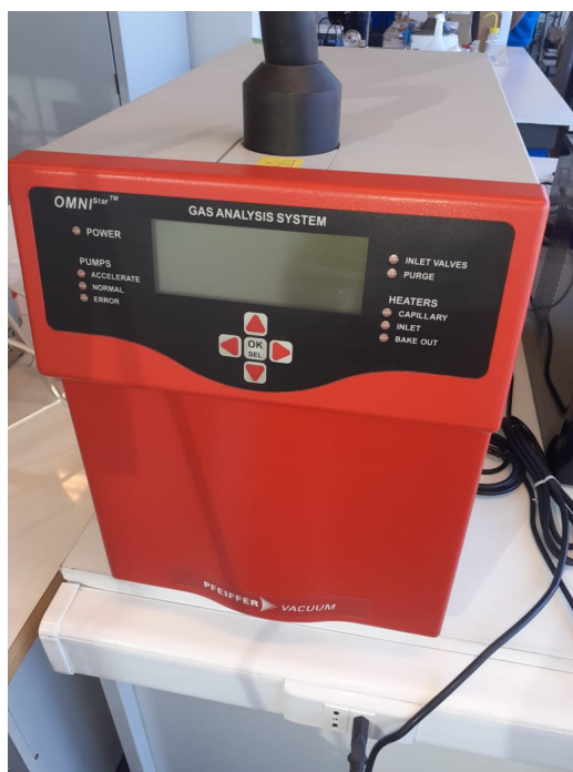
Figura 2.14: Espectrómetro OMNI Star TM modelo GSD 320 , disponible en el Laboratorio de Catálisis.
