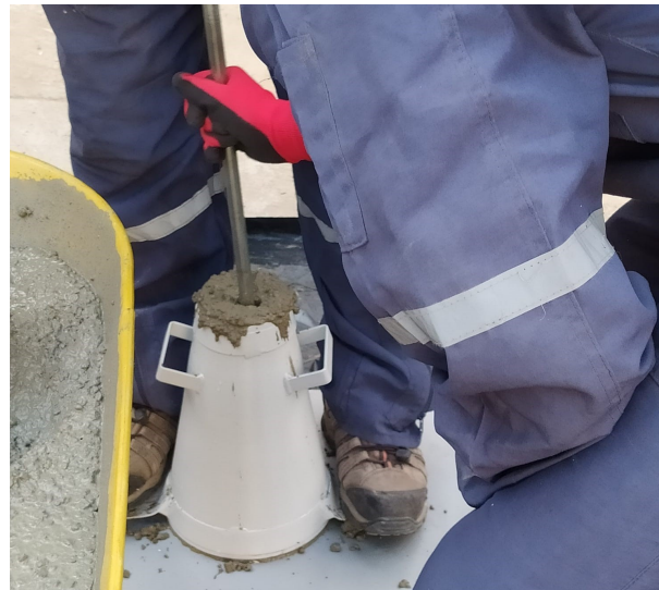
(c) Vertido y Apisonamiento de la Tercera Capa de Hormigón
