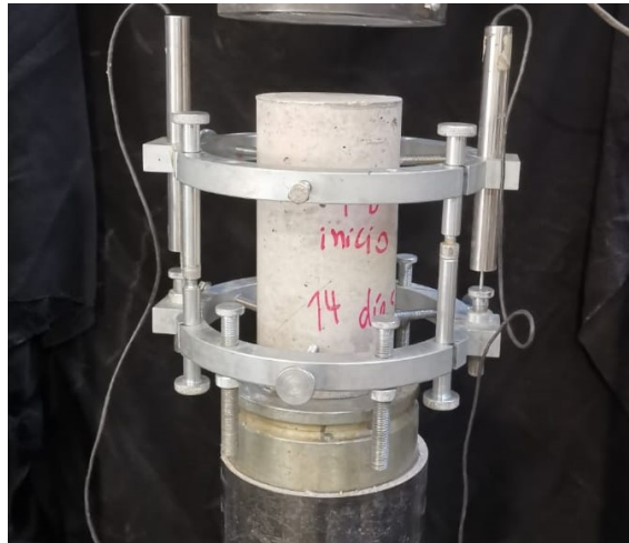
Figura 4.11: Fijación de LVDT's Para Medición de Deformaciones a Compresión
