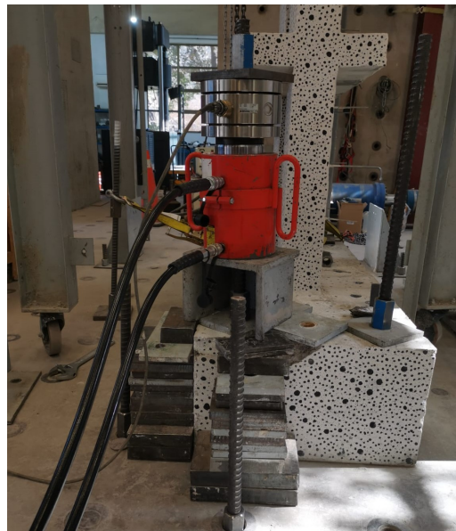
(c) Forma Recomendada Para Postensar Barras en los Extremos del Pedestal
