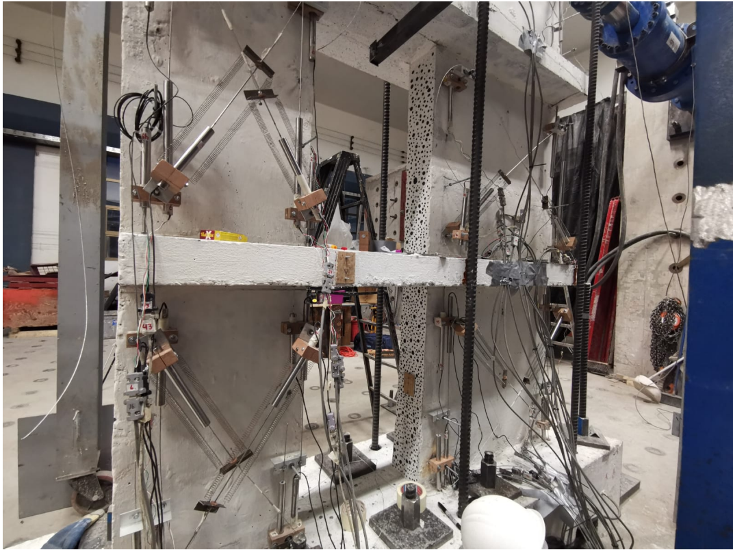
Figura 4.33: Instrumentos Instalados en el Muro.
