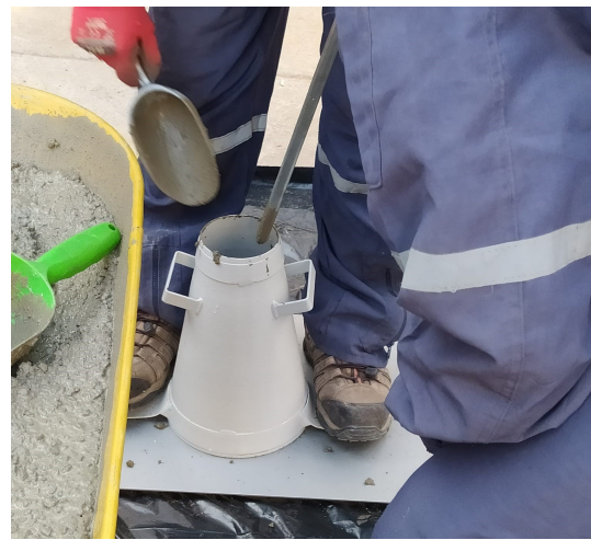
(b) Vertido y Apisonamiento de la Primera Capa de Hormigón
