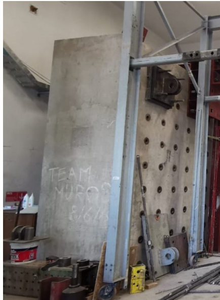
Figura 4.17: Muro de Reacción
