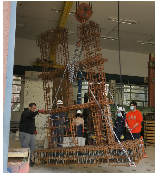
(b) Instalación y traslado de la probeta al interior del laboratorio
