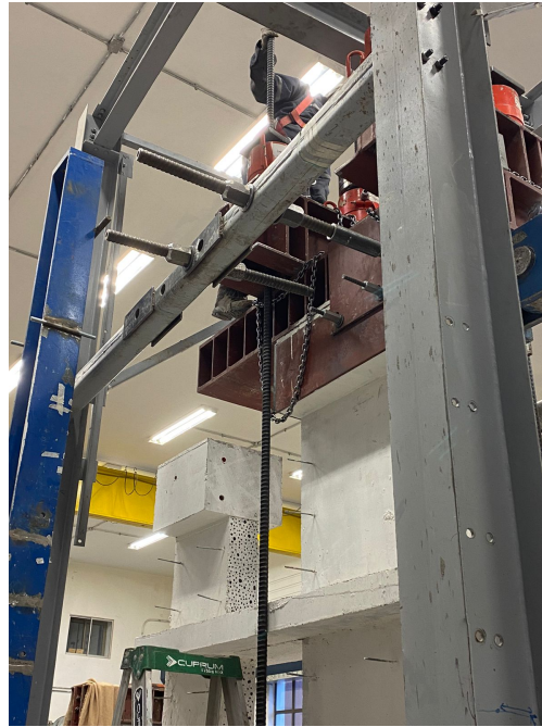
(b) Disposición de Barras para Restricción Fuera del Plano
